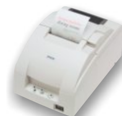
Jehličková tiskárna pro tisk vážních lístků
